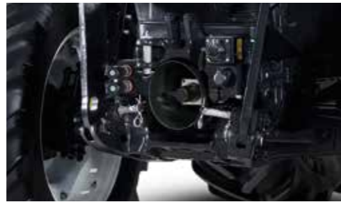
Nuovo design della PTO anteriore con frizione in bagno d'olio
