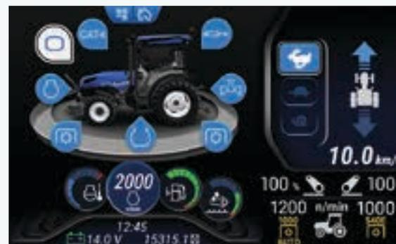
La pantalla principal le conduce fácilmente a 8 submenús para ajustar funciones como el caudal de aceite hidráulico, los automatismos de TDF, el tamaño de los implementos, la gestión de la cabina Blue Cab™ 4, etc. Gracias a su diseño y ergonomía, esta pantalla permite mantener una visibilidad perfecta del exterior de la cabina.
