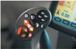
Les boutons à effleurement sont rétroéclairés pour faciliter l'utilisation des commandes dans l'obscurité.
