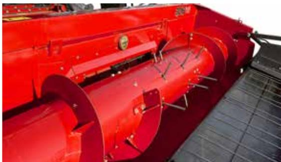
L'ampio diametro della coclea garantisce il trasferimento di andane ad alta densità verso la mietitrebbia
