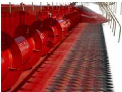
Possibilità di impostare la posizione della lama in modalità interamente idraulica dalla cabina, fino a un massimo di 575 mm e in movimento.
