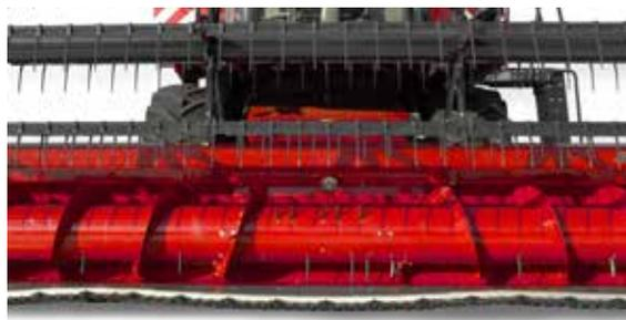
La lama segue i contorni del terreno, garantendo la raccolta di ogni singolo baccello.
