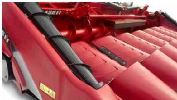
Coclea a forma di spirale per raccolti di prodotti allettati e cavità di ritenzione della granella - Design efficace per evitare le perdite
