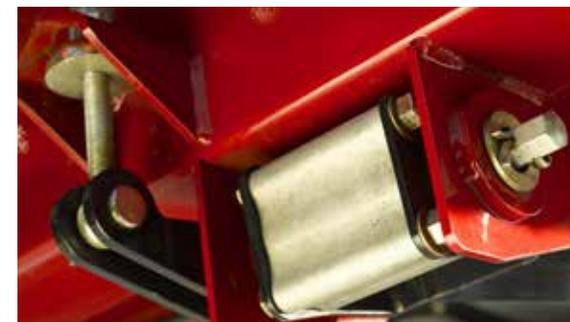
Blocchi di torsione regolabili per controllare il galleggiamento della lama sul terreno
