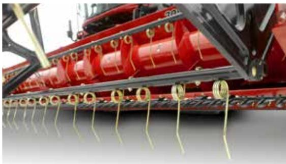
Importante vantaggio: i denti sporgono 7,5 cm al di sotto della barra falciante, facilitando il sollevamento del prodotto e riducendo i danni alla lama.
