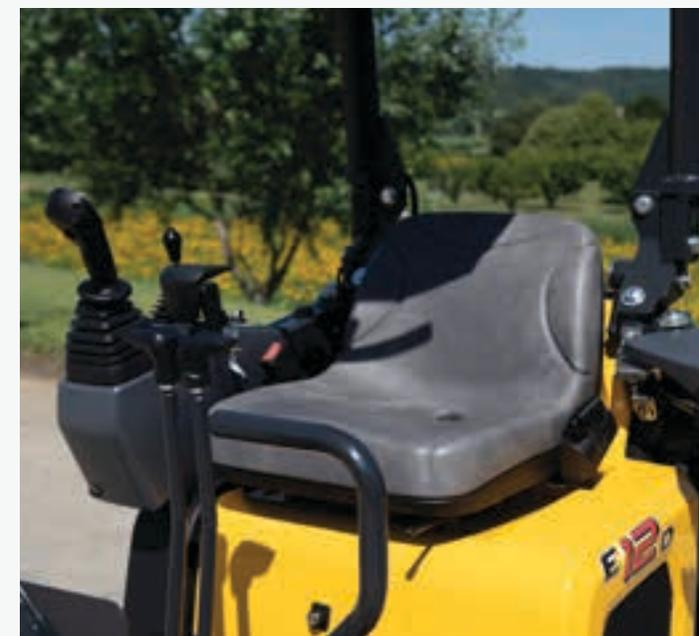
La postazione dell'operatore è stata progettata per essere quanto più confortevole e funzionale possibile. L'accesso per utilizzare la macchina è facilitato dal bracciolo sinistro pieghevole, che permette di accomodarsi sul sedile dell'operatore senza compromessi in termini di comfort o di sicurezza.
