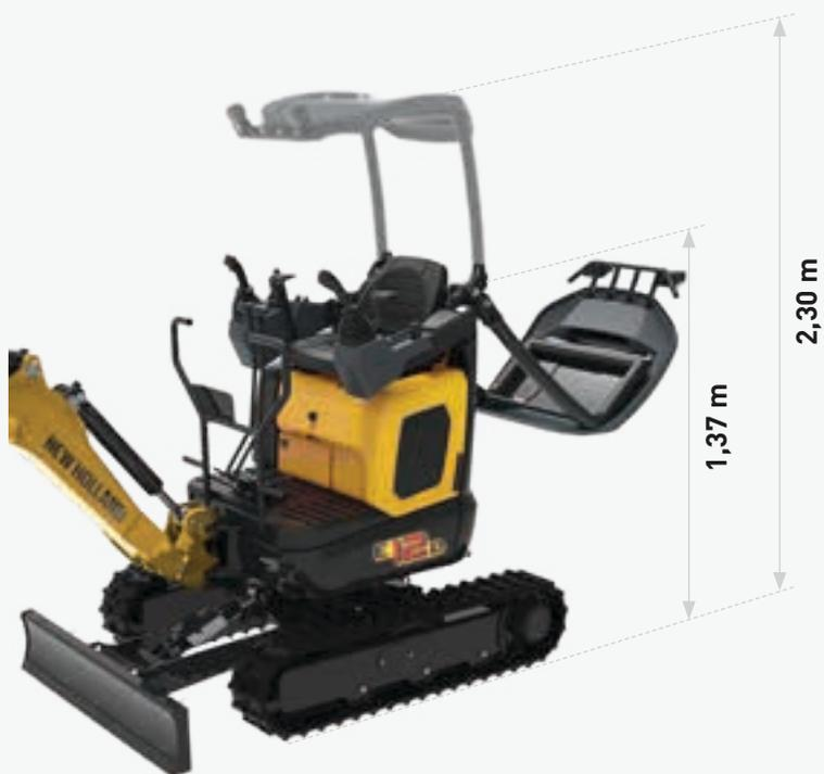
Dovete accedere a un ambiente con un soffitto o una porta bassa? Il roll-bar pieghevole è facile da usare e consente di parcheggiare la macchina utilizzando uno spazio minimo.
