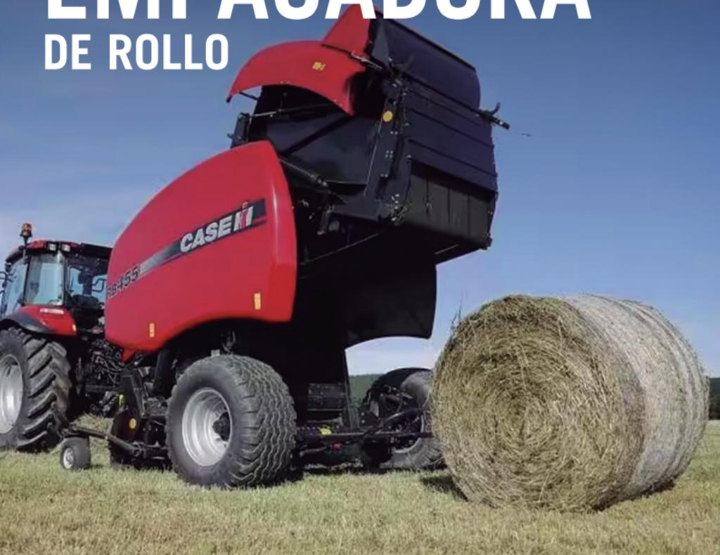
Las empacadoras de rollo Case IH RB5 producen pacas consistentemente densas en forma de rollo, incluso en condiciones variables del campo y cultivo.
