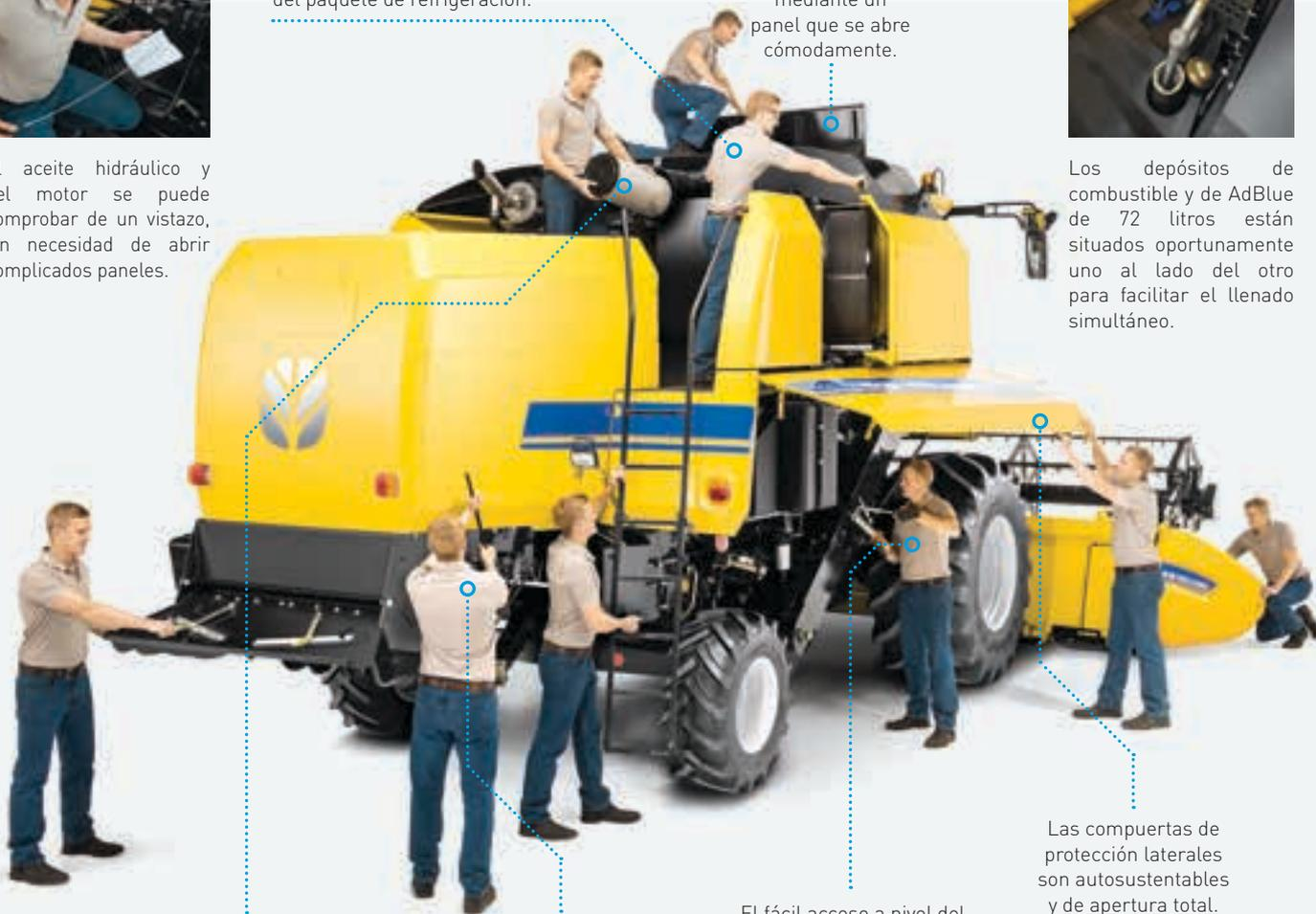
Al filtro de aire se accede fácilmente desde la plataforma del motor.
