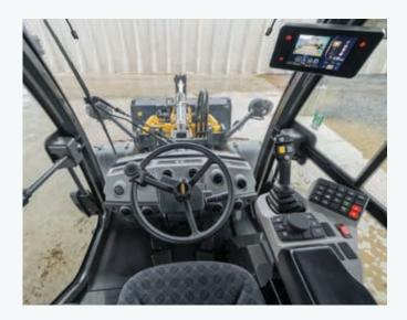
Die neu gestaltete Kabine des W100D überzeugt mit einer erhöhten Sitzposition und großzügigen Glasflächen zwischen vier schmalen Säulen. Dadurch genießen Fahrer eine nahezu uneingeschränkte 360°-Sicht. Ein heller, luftiger Innenraum und ein Geräuschpegel von lediglich 71 dB(A) schaffen optimale Bedingungen für konzentriertes und komfortables Arbeiten.
