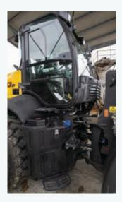
Die großzügig gestaltete Kabine des W100D ist vollständig in das Maschinenkonzept integriert und verfügt über eine ROPS/FOPS-Zertifizierung der Stufe 2. Vollverglaste Türen auf der linken und rechten Seite ermöglichen einen einfachen Zugang und eine uneingeschränkte Rundumsicht beim Manövrieren, was sowohl die Sicherheit als auch die Arbeitseffizienz maximiert. Haltegriffe wurden genau dort angebracht, wo sie benötigt werden, um ein sicheres Ein- und Aussteigen zu gewährleisten.
