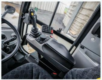
Um eine ergonomische, intuitive und komfortable Umgebung für den Fahrer zu gewährleisten, wurden die Bedienelemente strategisch günstig in Reichweite des Multifunktions-Joysticks in der rechten Armlehne angeordnet. Für maximalen Sitzkomfort ist die Armlehne am luftgefederten Fahrersitz montiert und bewegt sich selbst auf unebenem Gelände mit.
