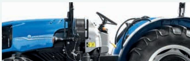
Struttura ROPS a montaggio centrale con ammortizzatore a gas, specifica per la frutticoltura
