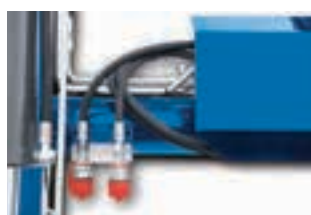
500TL: Acopladores del tercer servicio
