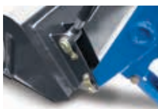
300TL: Conexión del implemento mediante pasador
