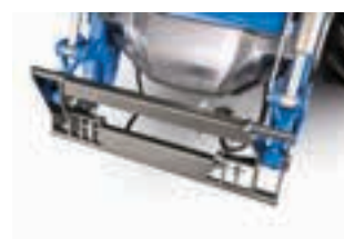
600LA y 700LA: Bloqueo hidráulico del implemento
