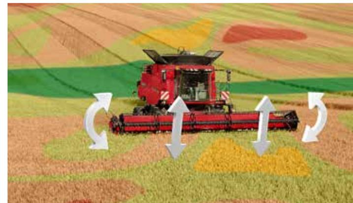
La technologie Terrain Tracker de Case IH assure une hauteur de coupe exacte et uniforme, même dans les champs irréguliers.
