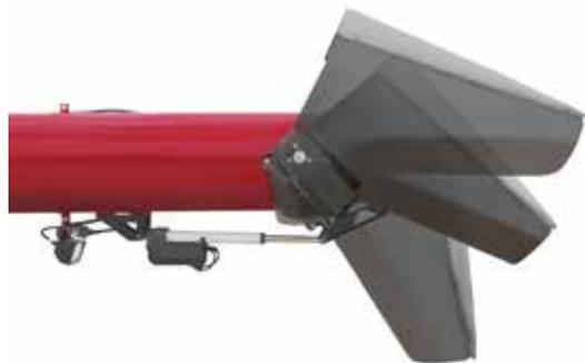
L'option d'embout sur pivot est actionnée avec le levier multifonction. Elle oriente le flux de grains dans la benne et permet de la remplir au maximum sans débordement.
