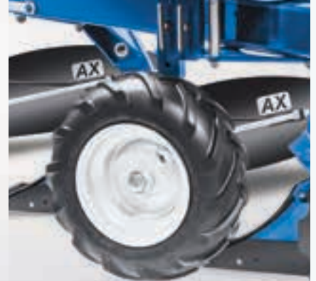
Dubbelhjul, mittmonterat – 23x8.50-12
