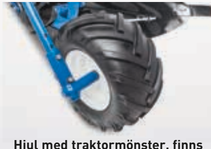
Hjul med traktormönster, finns även med hydr. djupreglering – 26x12.00-12
