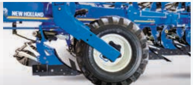
Sidomonterat kombihjul – 11.5/80-15.3 Sidomonterat kombihjul – 11.5/80-15.3 Hydr. djupreglering
