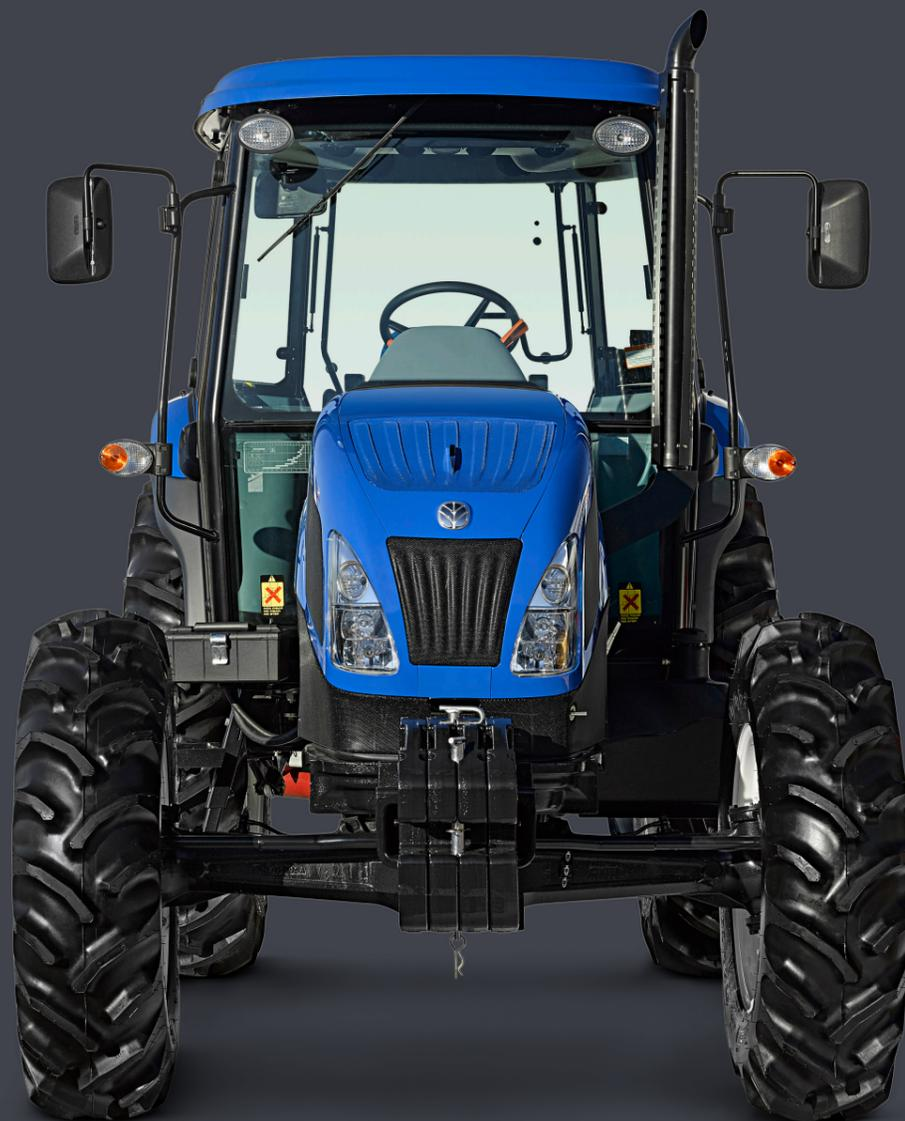
A TDF do TL5 tem o acoplamento progressivo e é independente, dispensando a parada do trator para o seu acionamento. Além da velocidade de 540 rpm, oferece opção de TDF econômica e o sistema de velocidade sincronizada com a roda. Esse sincronismo permite que, caso seja acionada a ré, o sentido de torção do eixo da tomada de força seja invertido, facilitando o desembuchamento de implementos como ensiladeira.
