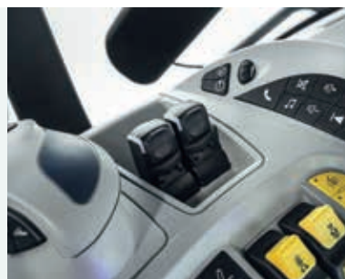
Optioneel paneel voor afstandsbediening hydraulica met 2 hendels
