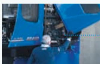
La apertura total del capó del motor de dos piezas ofrece acceso completo para el mantenimiento: la pieza frontal totalmente abatible facilita el acceso al motor, mientras que la puerta lateral se mueve con un amortiguador de gas para la limpieza y el mantenimiento del sistema hidráulico y los radiadores.
