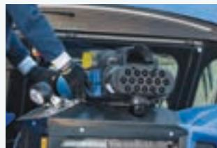
Es fácil inspeccionar, limpiar o sustituir el filtro de aire del motor sin necesidad de herramientas y desde el suelo.
