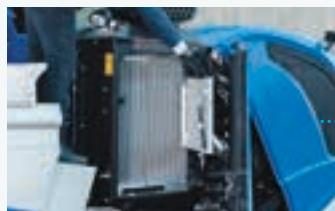
El sistema de refrigeración se abre para facilitar y agilizar la limpieza.
