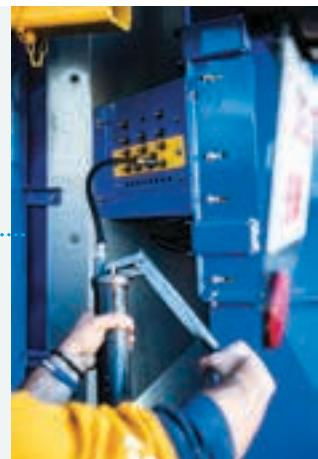
Para facilitar y reducir el mantenimiento, todos los puntos de engrase del cabezal recolector se han agrupado en una única zona con fácil acceso desde el suelo.
