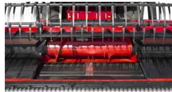
Możliwość zmiany kierunku ruchu środkowego pasa podającego oraz przenośnika ślimakowego w celu usunięcia zatoru
