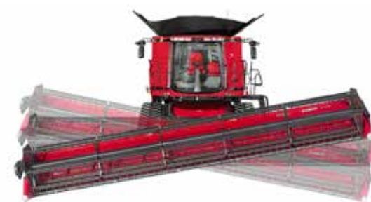
Stosowana przez markę Case IH technologia Terrain Tracker zapewnia utrzymywanie zadanej wysokości koszenia nawet na najbardziej nierównym terenie.
