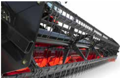
Regulowany nagarniacz może być wyposażone w palce z tworzywa sztucznego lub stali.
