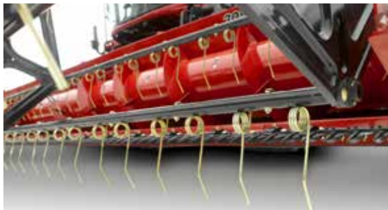
Wymierna zaleta: Palce sięgają 7,5 cm poniżej listwy nożowej, podnosząc uprawę i minimalizując ryzyko uszkodzenia zespołu tnącego.
