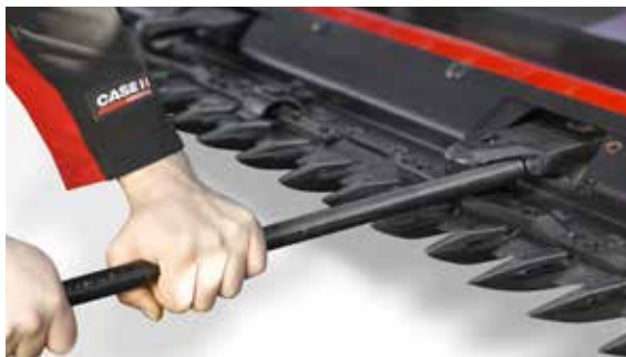
Proste serwisowanie centralnego napędu kosy
