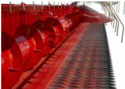
Hydrauliczna regulacja położenia kosi z kabiny podczas pracy w zakresie do 575 mm.
