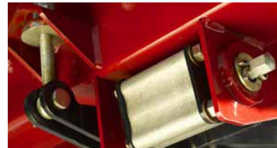
Regulowane bloki skrętne umożliwiają kosie podążać za ukształtowaniem terenu.
