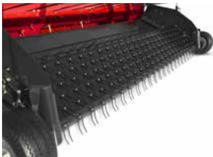
Szeroki pas podbieracza zapewnia podbieranie wszystkich roślin nawet z pokosów o nieregularnym kształcie.
