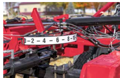
Profondeur des groupes de lames : former une couverture de résidus agronomiques
