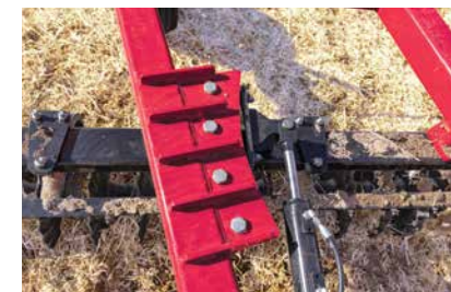
Pression sur les groupes de lames : réduit la pression sur le châssis
