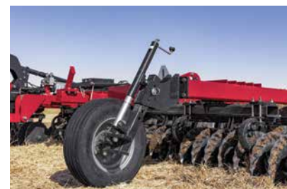
Roues stabilisatrices : améliorent la maniabilité et le contrôle
