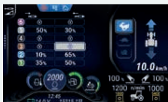
Configuração do caudal das válvulas remotas eletro-hidráulicas
