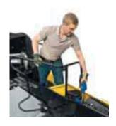
O depósito de combustível e o depósito de AdBlue® com capacidade para 120 litros estão próximos um do outro para facilitar o enchimento simultâneo.
