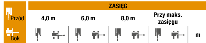
RTC - Długość 2,50 m, stopy 600 mm. Maksymalny zasięg 9,38 m
