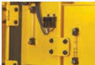
Des niveaux en verre permettent une vérification rapide et sans avoir à soulever le capot du moteur.
