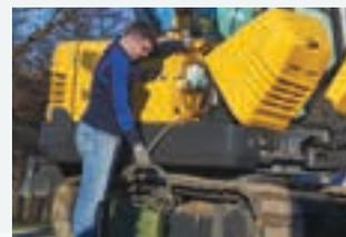
Une pompe électrique distante de recharge est disponible en option sur les modèles E57C et E60C.
