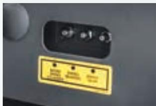
Points de graissage centralisé.
