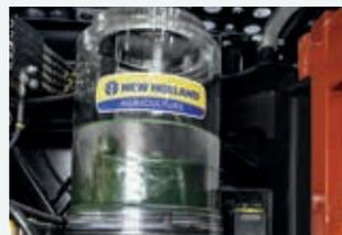
Die automatische Zentralschmierung ist leicht zugänglich.
