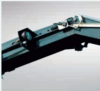
Sechs Arbeitsscheinwerfer sind an wichtigen Arbeitsbereichen montiert, u.a. am Auswurfkrümmer, an der Wartungsplattform und auf dem Stoßfänger zur Ausleuchtung des Frontbereichs.
