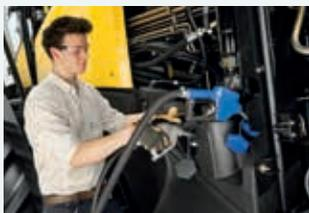
Der Kraftstofftank und der 200 Liter fassende AdBlue-Tank sind nebeneinander montiert, was das Nachfüllen erleichtert.
