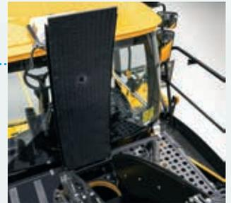
Die weit aufstellbaren Seitenverkleidungen ermöglichen einen uneingeschränkten Zugang zu allen Antrieben und Wartungspunkten.
