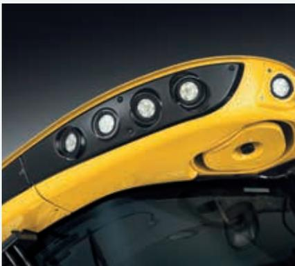
Die Beleuchtungsanlage des FR umfasst bis zu 20 Arbeitsscheinwerfer (17 LED-Scheinwerfer) 11 LED-Scheinwerfer sind so im Dach angeordnet, dass eine optimale Lichtverteilung gewährleistet ist.
