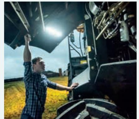
LED-Leuchten unter den Verkleidungen erleichtern die Ausführung von Wartungsarbeiten bei widrigen Lichtverhältnissen.
