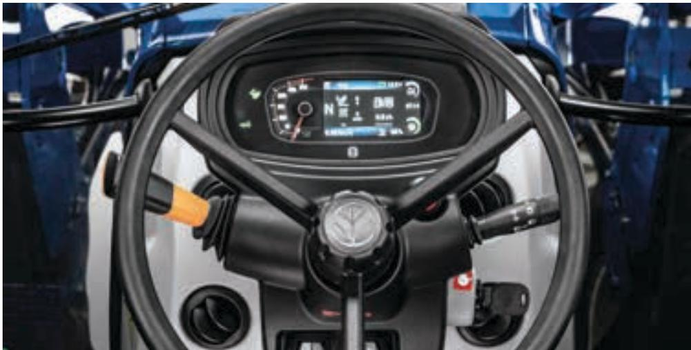
Os interruptores basculantes de elevada qualidade proporcionam uma operação positiva e precisa das funções principais, enquanto um novo quadro de instrumentos com ecrã de informação digital fornece dados claros e precisos sobre todas as funções importantes, mantendo-o bem informado sobre o desempenho do trator e o estado das principais áreas, como o nível de combustível e a velocidade do motor. O resultado? Obtém mais da sua máquina.
