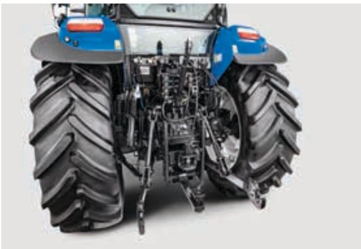
Equipe um T5 da New Holland com um engate dianteiro e uma TDF e terá um trator ainda mais versátil. O novo design da TDF de embraiagem em banho de óleo não necessita de manutenção e garante um funcionamento mais silencioso.
