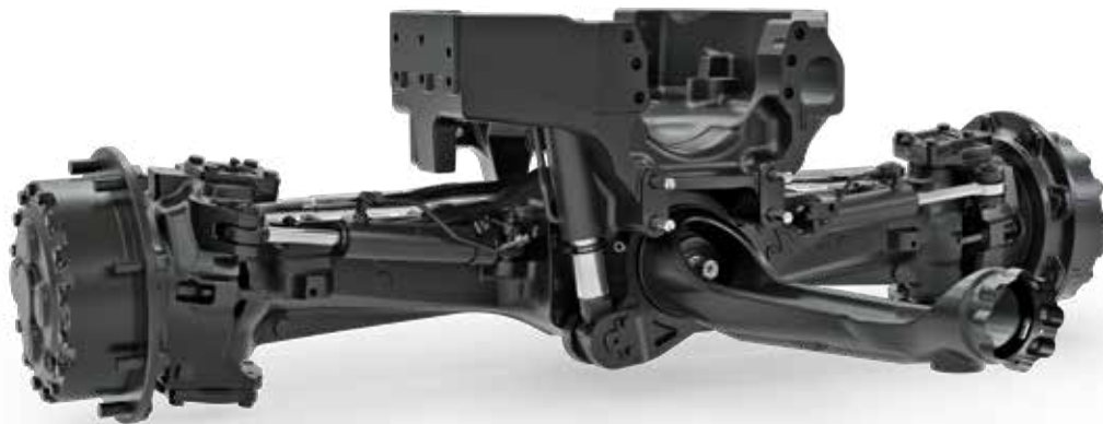
Die Vorderachsfederung wirkt in beide Richtungen: mehr Komfort, Traktion und Sicherheit.
