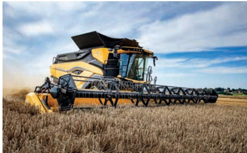
Il Cursor 13 da 12,9 litri della CR10 eroga fino a 634 CV a 1.800 giri/min, ed è alimentato da un serbatoio diesel da 1.300 litri per incrementare al massimo la produttività quotidiana. La CR11 monta un motore Cursor 16 FPT da 15,9 litri. I sei cilindri di questo potente propulsore generano fino a 775 CV, rendendolo capace non solo di gestire di enormi volumi di raccolto, ma anche di lavorarli nel migliore dei modi.
