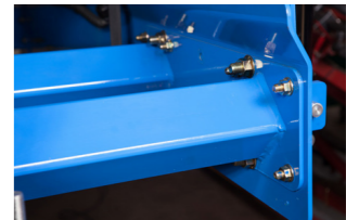
Chassi modular com travessias inclinadas: evitam o acúmulo de adubo.
