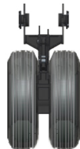
Rodado com eixo curto: mais durabilidade e resistência, correntes protegidas. Pneus com garra de fábrica.
