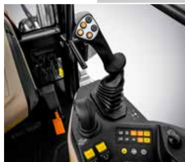
OPTIONELE JOYSTICK VOOR NAUWKEURIGE BEDIENING VAN EH REGELVENTIELEN
