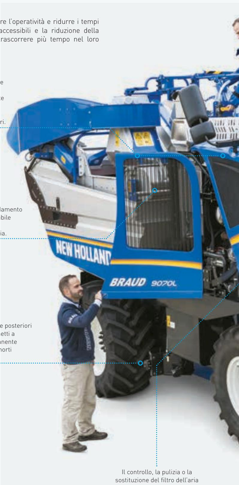
L'operazione di lavaggio non è mai stata così facile, grazie alla speciale piattaforma di accesso, al nuovo tipo di valvola e di tubo di alimentazione dell'acqua e anche ai pulsanti posizionati esternamente su uno dei montanti della cabina.
