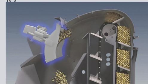
O sensor de produtividade exclusivo da New Holland gera medidas de fluxo de grão extremamente precisas. Ademais, só precisa de uma calibração por safra.
