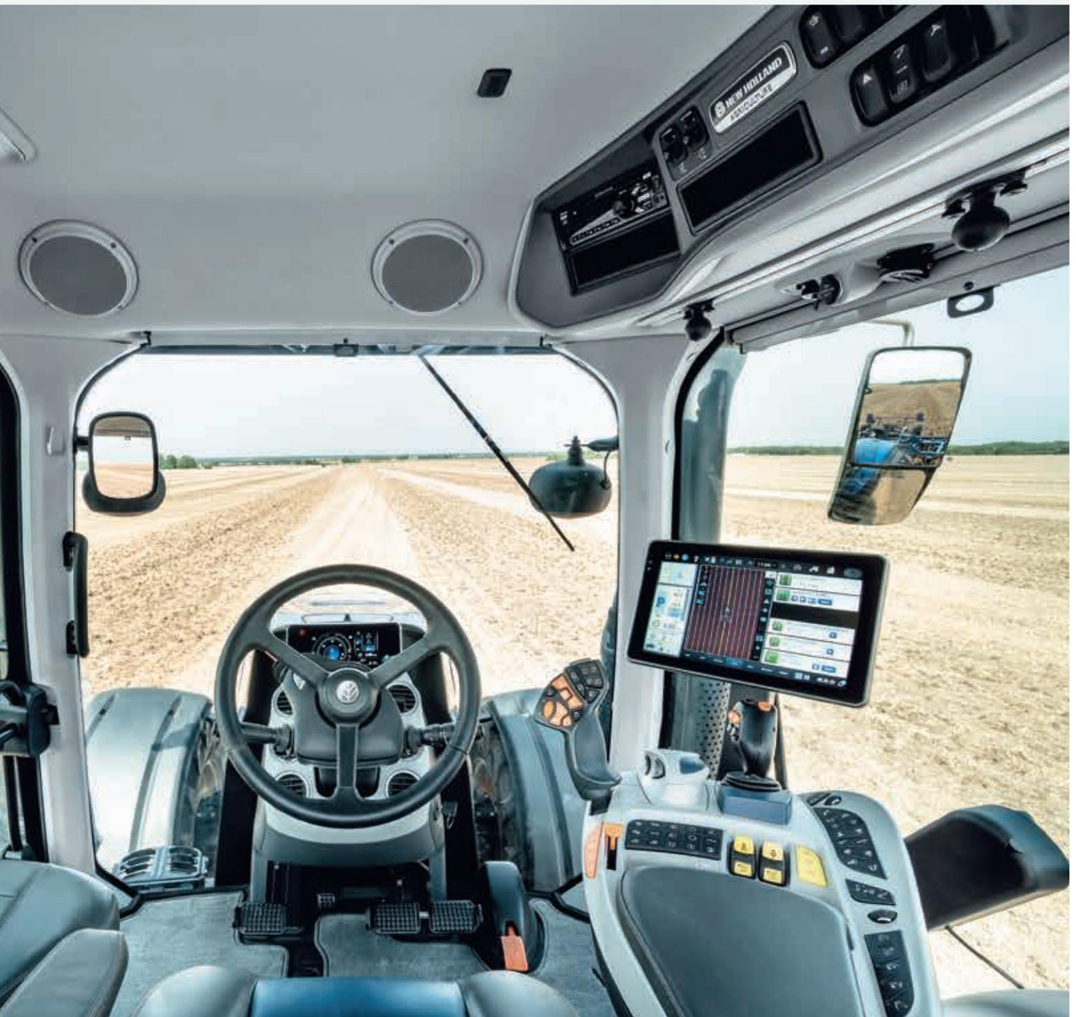
Die Verbundfrontscheibe, dickere Gummidichtungen an Fenstern und Türen, eine dickere Bodenmatte und die effektive Unterbodenisolierung sorgen dafür, dass es in der T8 Genesis™-Kabine flüsterleise ist.
