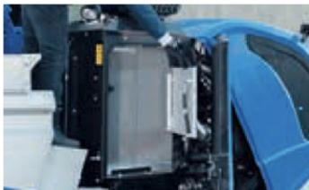
A abertura total do capô do motor em duas peças oferece acesso completo para manutenção: a parte frontal totalmente hidráulica e dos radiadores.
