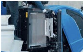
O sistema de refrigeração se abre para uma limpeza rápida e fácil.
