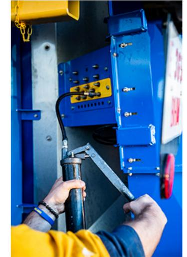
Para facilitar e reduzir a manutenção, todos os pontos de lubrificação da cabeça de colheita foram agrupados em uma única área com fácil acesso a partir do solo.
