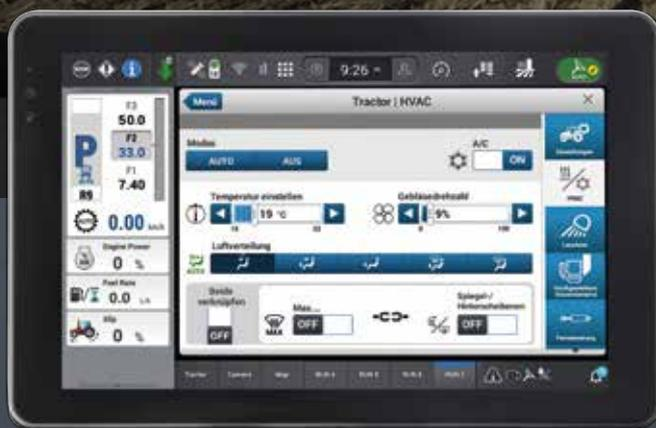
Le nouveau système de climatisation pressurisée comporte davantage de bouches et d'évents pour augmenter le flux d'air autour de l'utilisateur. Il peut également être commandé directement par l'encodeur ou par les boutons configurables.
