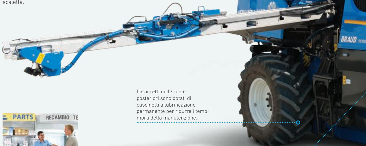
I braccetti delle ruote posteriori sono dotati di cuscinetti a lubrificazione permanente per ridurre i tempi morti della manutenzione.
