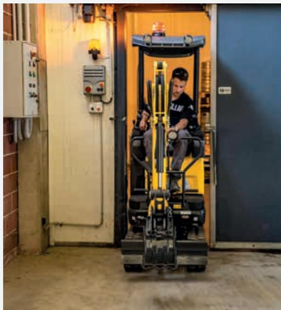
El tren de rodadura puede replegarse fácilmente y la cuchilla delantera plegarse para reducir la anchura total de la máquina de 1050 mm a 790 mm. Esto permite circular por pasajes estrechos.
