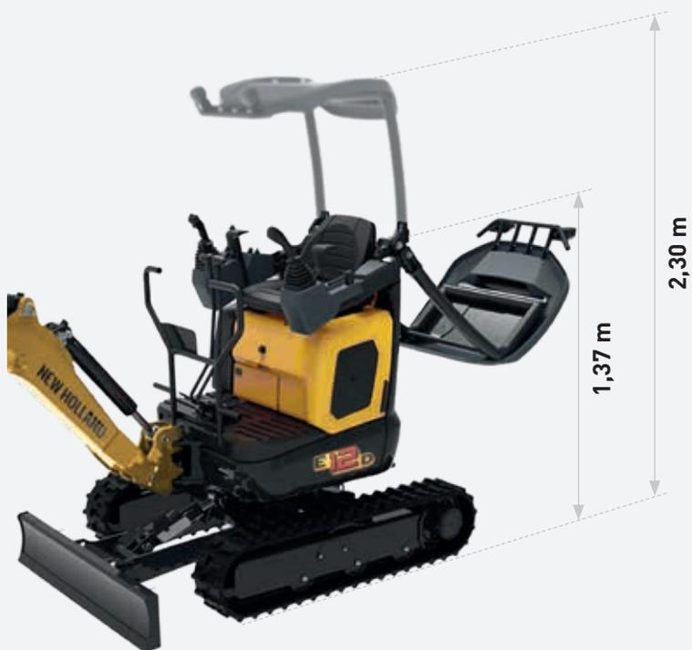
¿Necesita acceder a una habitación con techo o puerta de baja altura? La barra antivuelco plegable es fácil de abatir y permite que la máquina trabaje de manera compacta para ahorrar espacio en el edificio.
