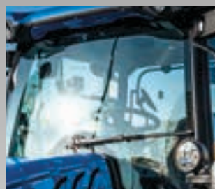
Faróis olho-de-gato distintos da New Holland com luzes LED características integradas
