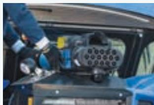
Accessible depuis le sol, le filtre à air moteur est facile à vérifier, nettoyer ou remplacer, sans outillage.
