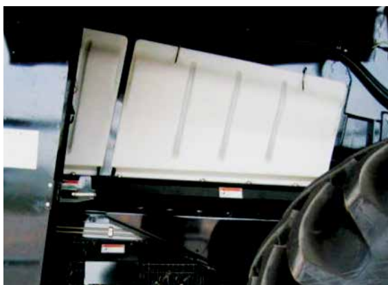
Rigtig god adgang til at foretage vedligeholdelse fra venstre side ved at afmontere de formede hvide plastafskærmninger
