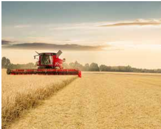
Spredning af lange strå - hurtig tørring af våde strå, derfor tidligere ballepresning efter vådt vejr
