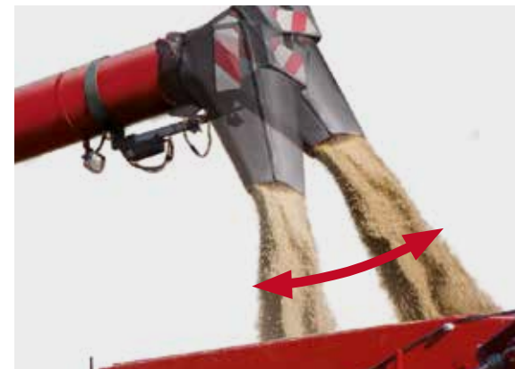
Vippetuden betjenes med multifunktionsgrebet og leder kornstrømmen ned i kornvognen, der fyldes til maksimalt niveau uden kornspild
