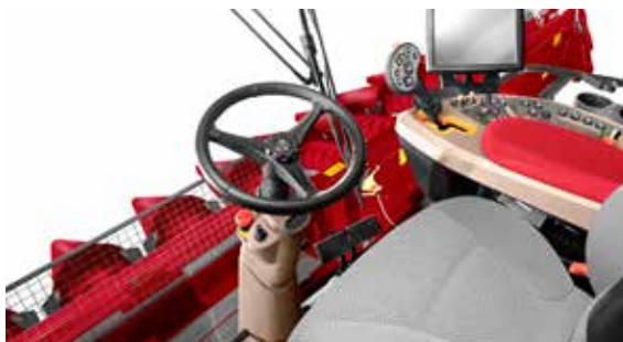
Ratstamme med foldefunktion og ny nødstopkontakt samt teleskoprat - uhindret udsyn
