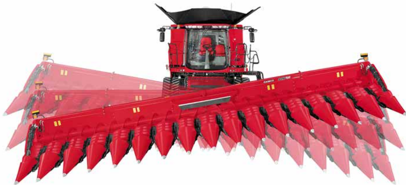
Case IH Terrain Tracker teknologi sikrer præcis skærehøjde, selv i meget ujævnt terræn
