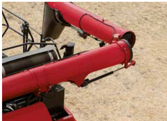
Tømme­sneglene på 8,8 og 10,4 m kan fås i sammenklappelig udgave, så de er nemmere at transportere på vejen og lettere at manøvrere på plads, når de skal opbevares
