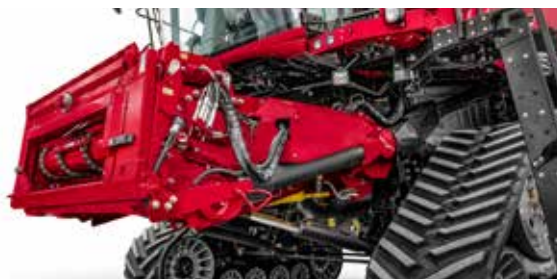
Frem-tilbage vipning med indstilling af skærebordets vinkel – al liggende afgrøde opsamles, minimalt spild
