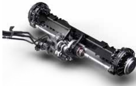
Nyt hydrostatisk drev og ny transmission giver øget trækraft. Oliekølede bremser med konstant bremsekraft
