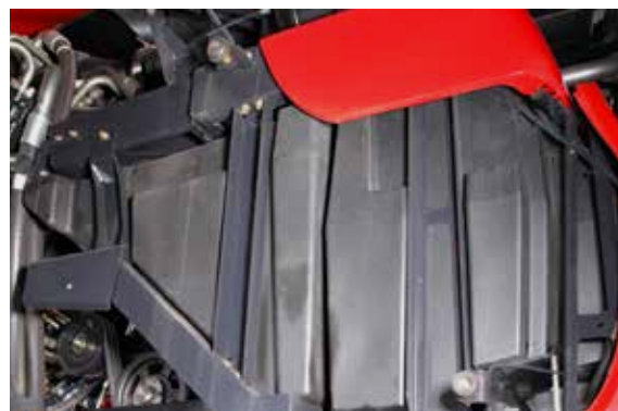
Brændstokkapacitet på 1.125 liter (7250, 8250) eller 1.200 liter (9250) til lange arbejdsdage. Når Xtra-Chopping snitteren er monteret, har 9250 en kapacitet på 1020 liter
