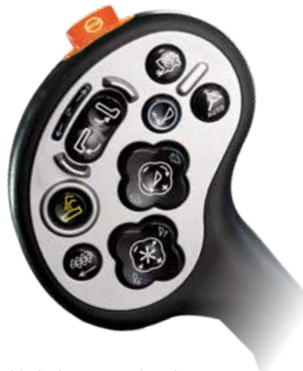
Indføringshastigheden kan styres med et tryk på en knap på multifunktionsgrebet
