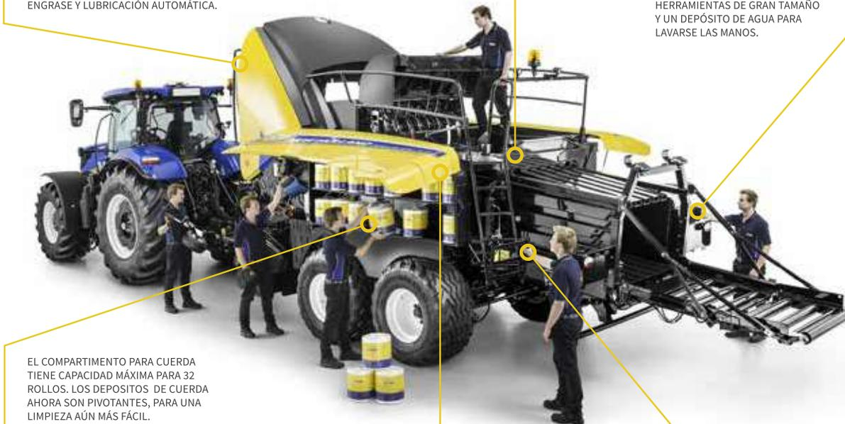
EL COMPARTIMENTO PARA CUERDA TIENE CAPACIDAD MÁXIMA PARA 32 ROLLOS. LOS DEPÓSITOS DE CUERDA AHORA SON PIVOTANTES, PARA UNA LIMPIEZA AÚN MÁS FÁCIL.
