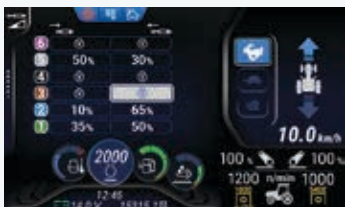
Ustawianie natężenia przepływu w zaworach hydrauliki zewnętrznej
