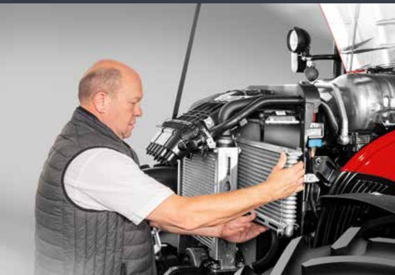
Einfache und schnelle Reinigung von Kühler und Klimaanlage.
