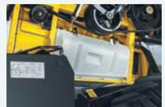
Die Kunststoff-Rotorabdeckungen können ohne Werkzeug demontiert werden.
