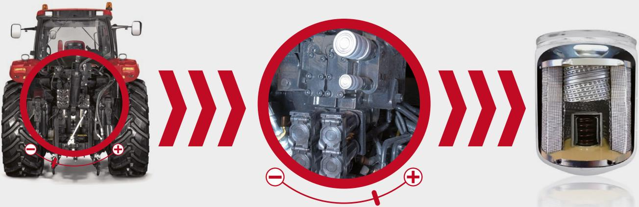
La función principal del filtro es **atrapar todas las partículas que tienen un efecto abrasivo** en los componentes del sistema hidráulico como la bomba, las válvulas de control, los cilindros y el motor hidráulico.
