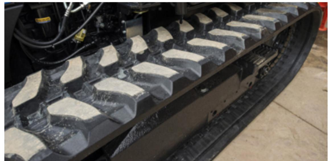
Além de ser altamente durável, a esteira de borracha SmartTrax™ garante nível elevado de tração, adesão lateral e reduz a compactação devido ao maior contato com o solo. Os menores níveis de vibração melhoram o conforto do operador, atendendo às normas de vibração ISO 2631.
