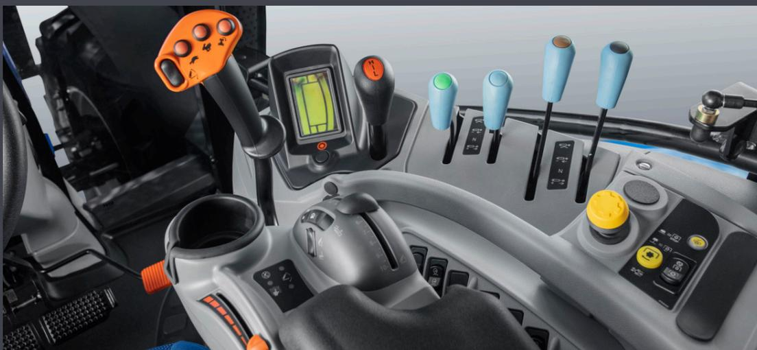
intuitivo monitor IntelliView™ IV, com informações sobre trator e implemento, possui função HTS (Headland Turn Sequence) para simplificar as operações graças às sequências automáticas de fim de linha, além disso o trator possui pré-disposição de piloto automático.
