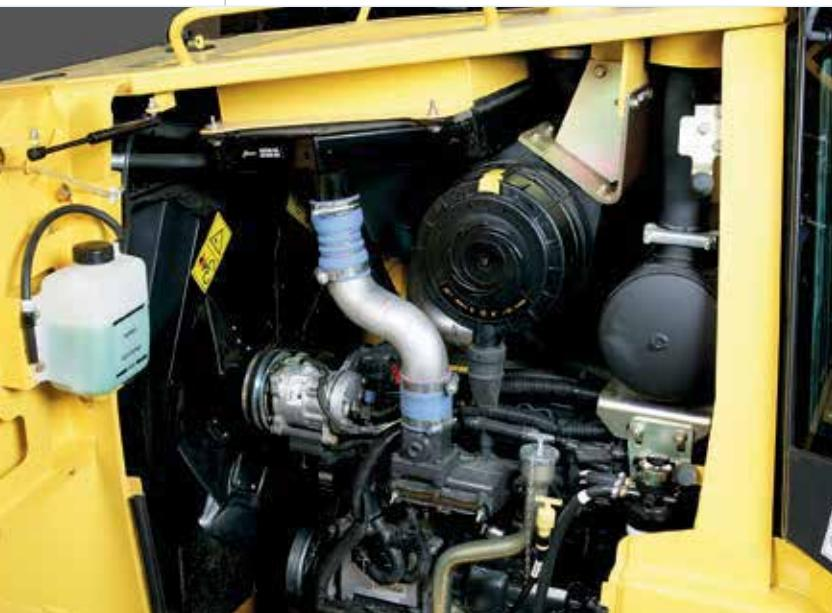
O motor eletrônico FPT Tier 3 (CONAMA MAR I) possui o que há de mais moderno em sistema de trem de força. É equipado com turbocompressor e sistema de refrigeração do tipo *intercooler*. A grande capacidade de torque e potência é garantida pela alta cilindrada (6,7 L), a qual é distribuída em 6 cilindros.
