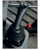
Na parte superior, dois interruptores permitem ao operador selecionar até 10 velocidades à frente, com uma velocidade máxima de avanço da máquina de 10 km/h. Ao ligar o motor, a velocidade de avanço é limitada a 60% da velocidade máxima.
