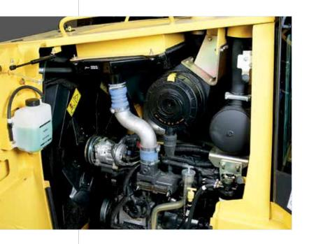
motor eletrônico FPT Tier 3 (CONAMA MAR I) possui o que há de mais moderno em sistema de trem de força. É equipado com turbocompressor e sistema de refrigeração do tipo *intercooler*. A grande capacidade de torque e potência é garantida pela alta cilindrada (6,7 L), a qual é distribuída em 6 cilindros.
