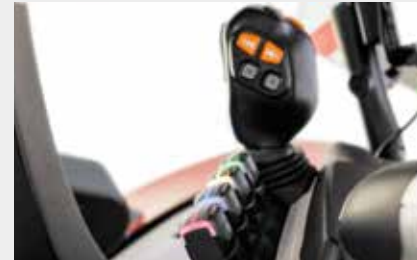
DE JOYSTICK BIEDT EEN NAUWKEURIGE BEDIENING VAN DE VOOR- EN ACHTERHEF MET ÉÉN VINGERBEWEGING – VOOR SOEPELER WERKEN.
