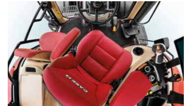
DE DRAAIBARE STOEL KAN TOT 40° DRAAIEN - VOOR EEN DUIDELIJK ZICHT OP DE WERKTUIGEN ACHTER EN MEER COMFORT TIJDENS LANGE WERKTIDEN.
