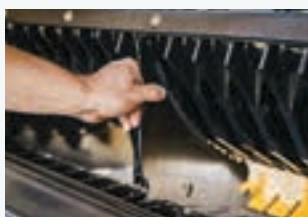
Nuevo rascador del rotor para mejorar el flujo de cultivo y reducir el consumo de energía.
