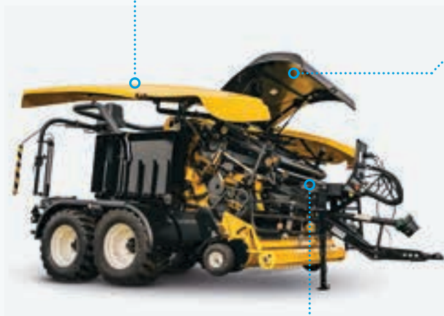
Actualización importante: transmisión y rascador del rotor nuevos, reducción de la acumulación de producto y otras mejoras de gran valor para el cliente
