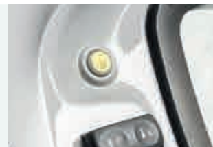
Włącznik WOM-u dla bezpieczeństwa operatora
