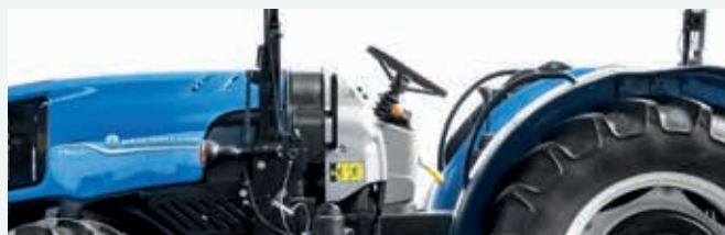
Międzyosiowa konstrukcja ROPS ze sprężyną gazową do pracy w sadach
