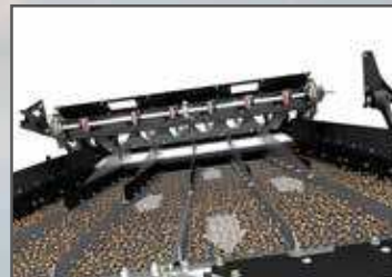
Dreschen in Hanglagen mit Cross-Flow-Reinigungssystem
