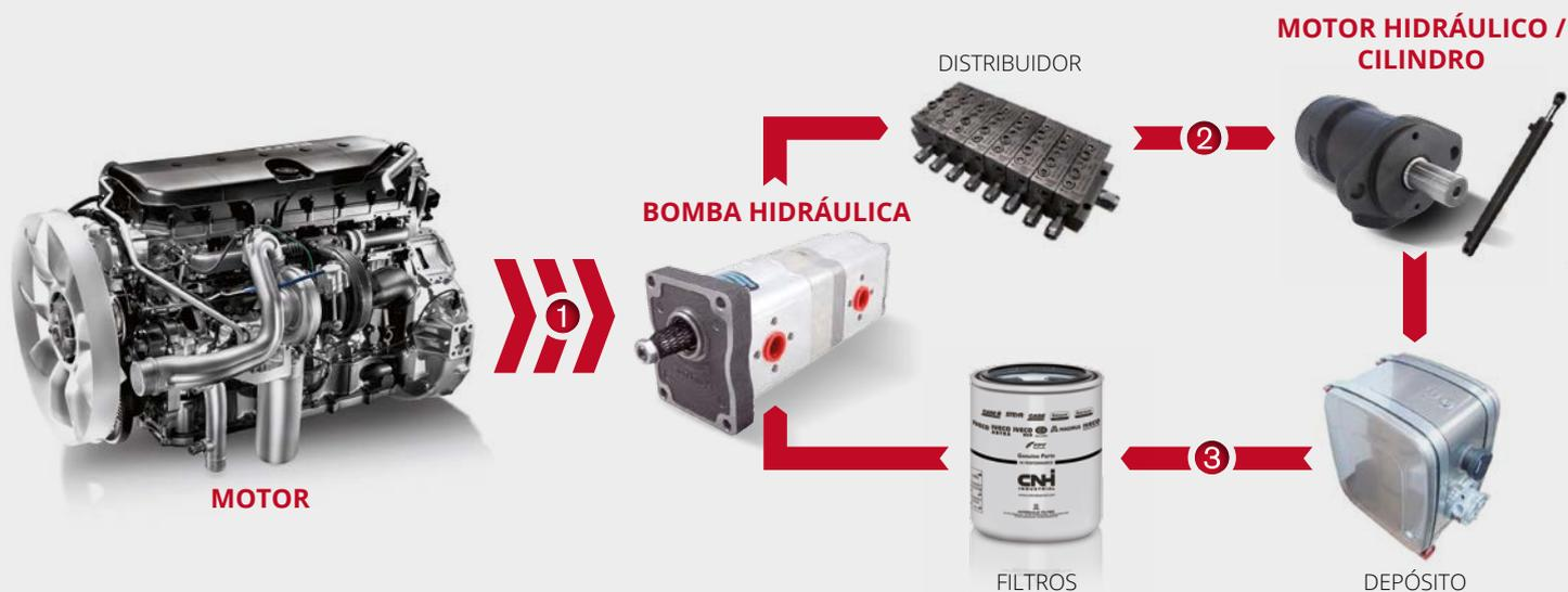
**1** La energía mecánica impulsa la bomba hidráulica para extraer el aceite del depósito.
